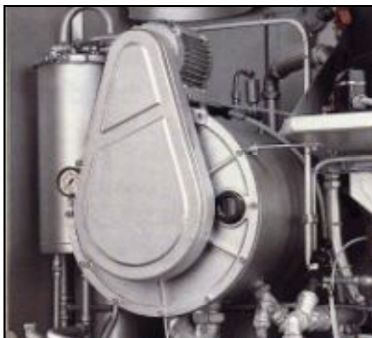
Figura 3: Filtro del solvente a dischi (autopulente)
