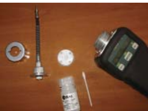
Fig.1: visuale esplosa del PID, flacone di alcool metilico ed un tampone
